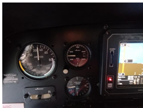
Фото вказівника повітряної швидкості на панелі приладів літака UR - MAC
