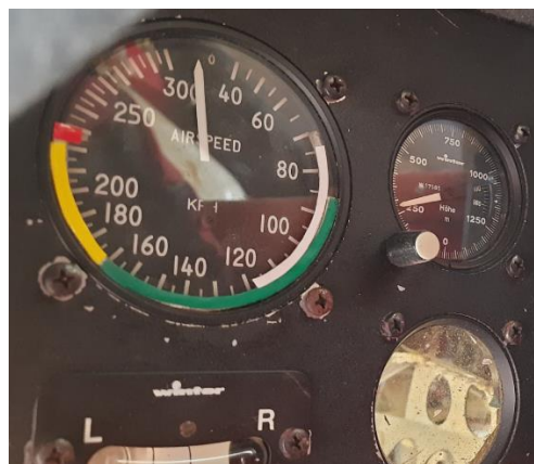
Фото вказівника повітряної швидкості на панелі приладів літака UR - KAI
