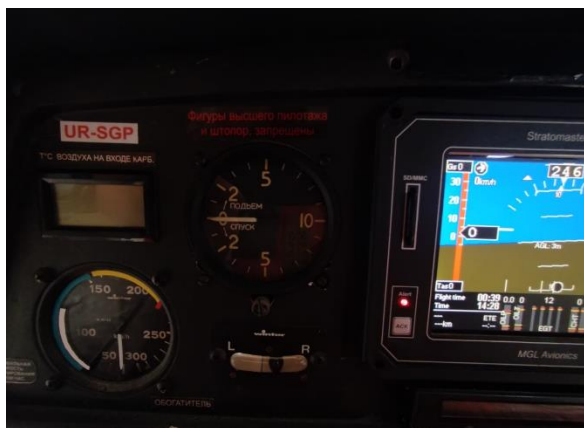
Фото вказівника повітряної швидкості на панелі приладів літака UR - SGP
