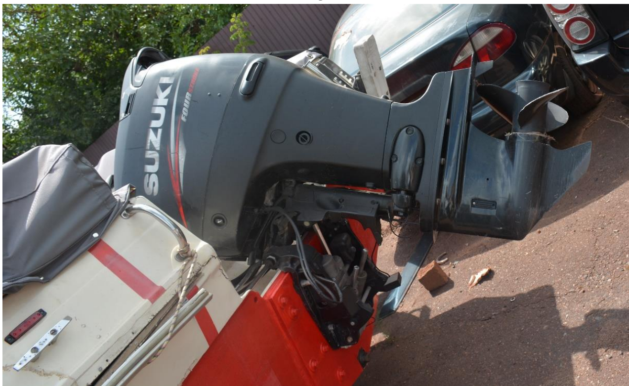
Фото 2. Мотор малого судна Azura-480 Open – Suzuki 140 DOHC (на фото видно, що синтетичне волокно намотане на гвинт)
