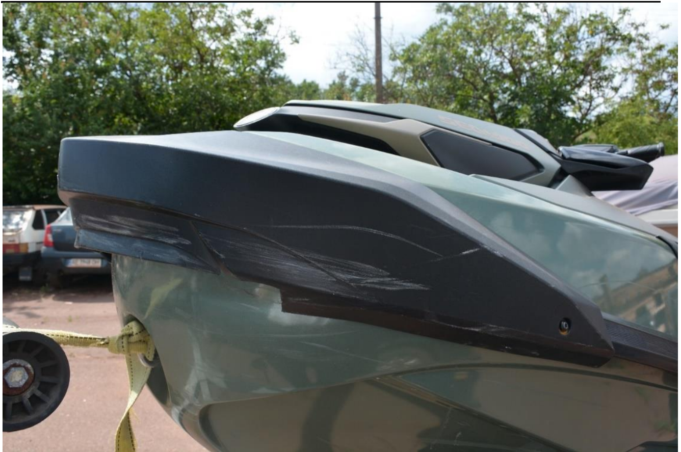
Фото 11. Носова частина гідроцикла після аварійної події. На фото видні поздовжні подряпини в напрямку взаємодії ТЗ в АП, відсутність елементів риштування форштевня (рами), які характеризують силу і вектор зіткнення ТЗ.
