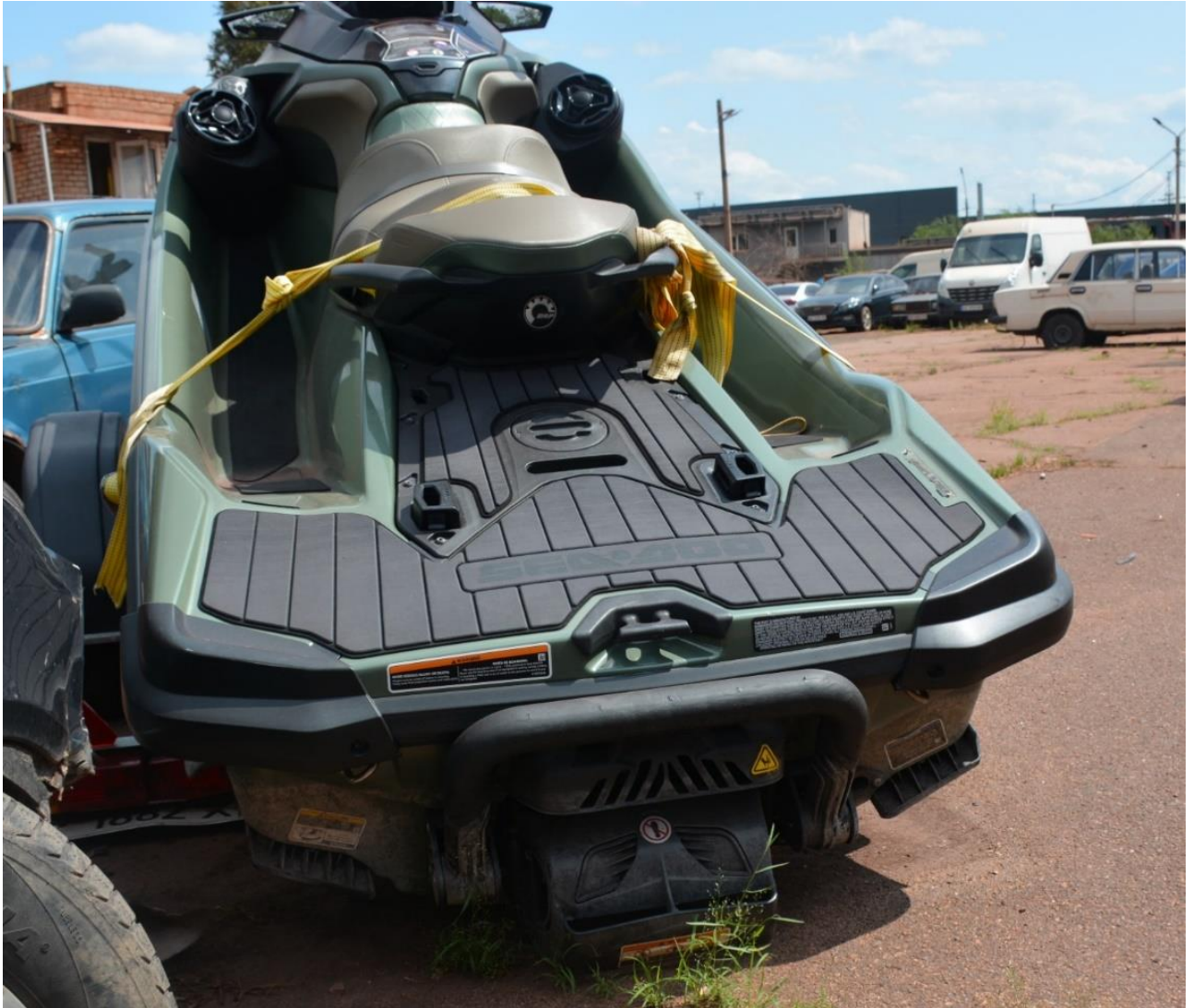
Фото 9. В нижній частині корми гідроцикла видно ковш iBR в активованому стані. 26 липня 2026.
