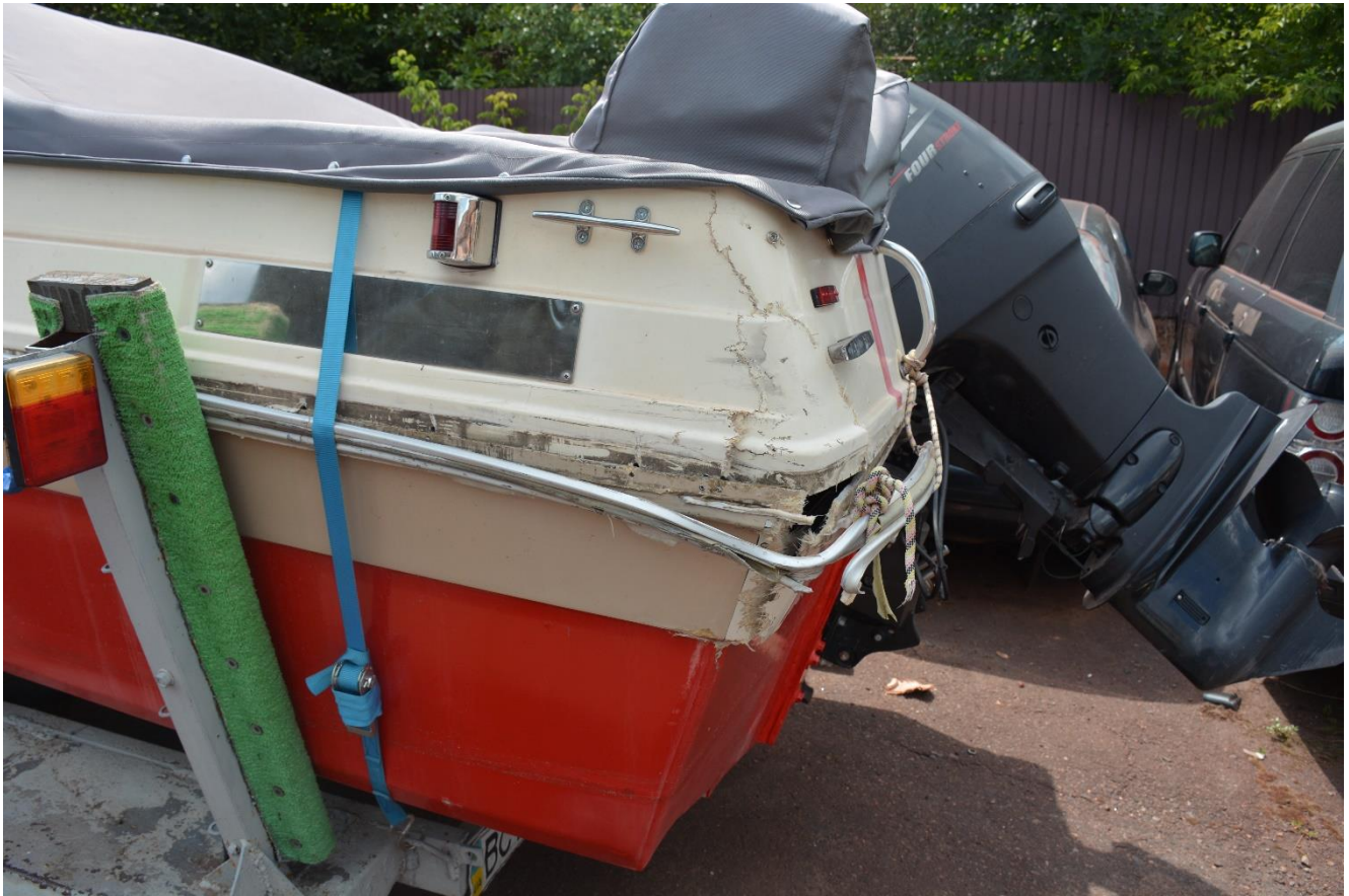
Фото 10. Пошкодження транця корми з лівого борту ММС. (Фото 28 липня 2026 року).
