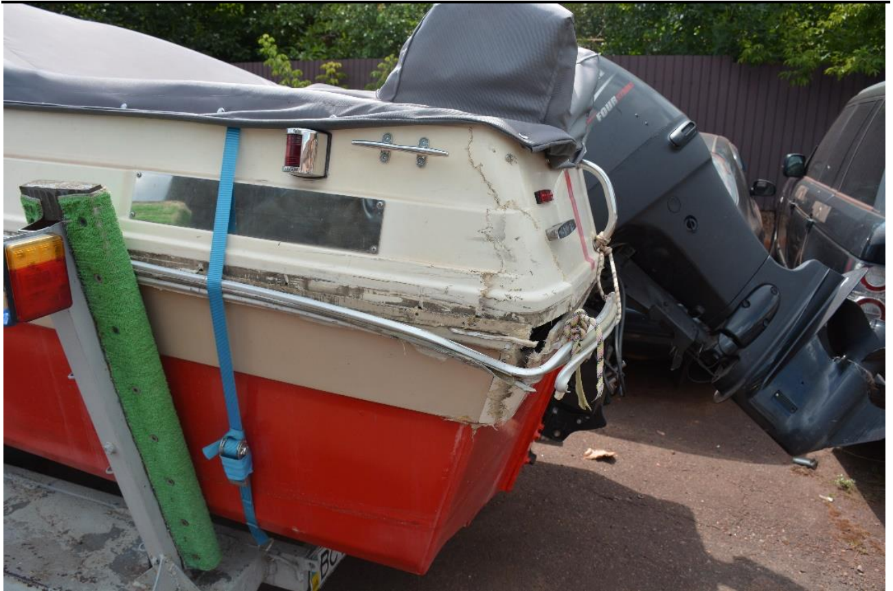
Фото 12. Пошкодження транца корми з лівого борту (Фото 28 липня 2026 року).
