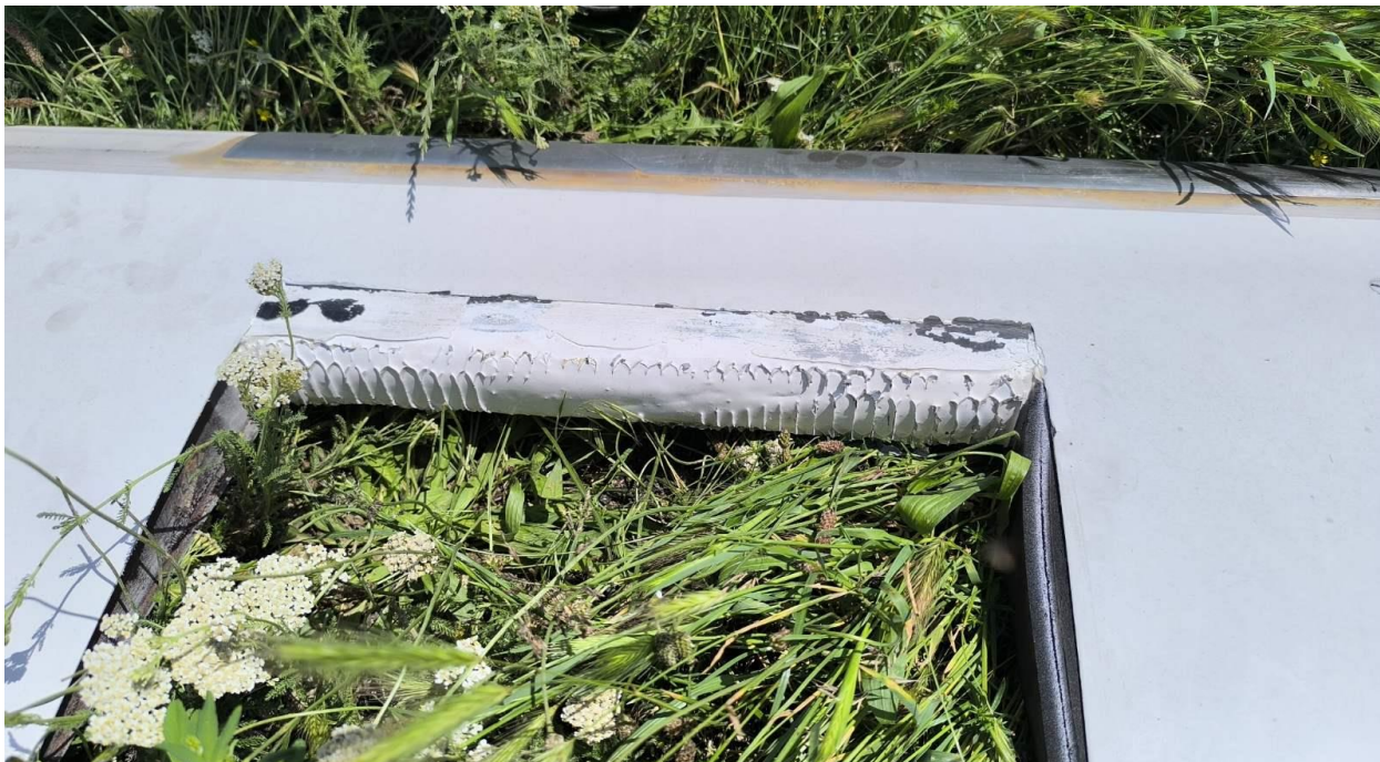
Пошкодження лопаті нижнього несучого гвинта № 7407УГ. (Вид знизу).
