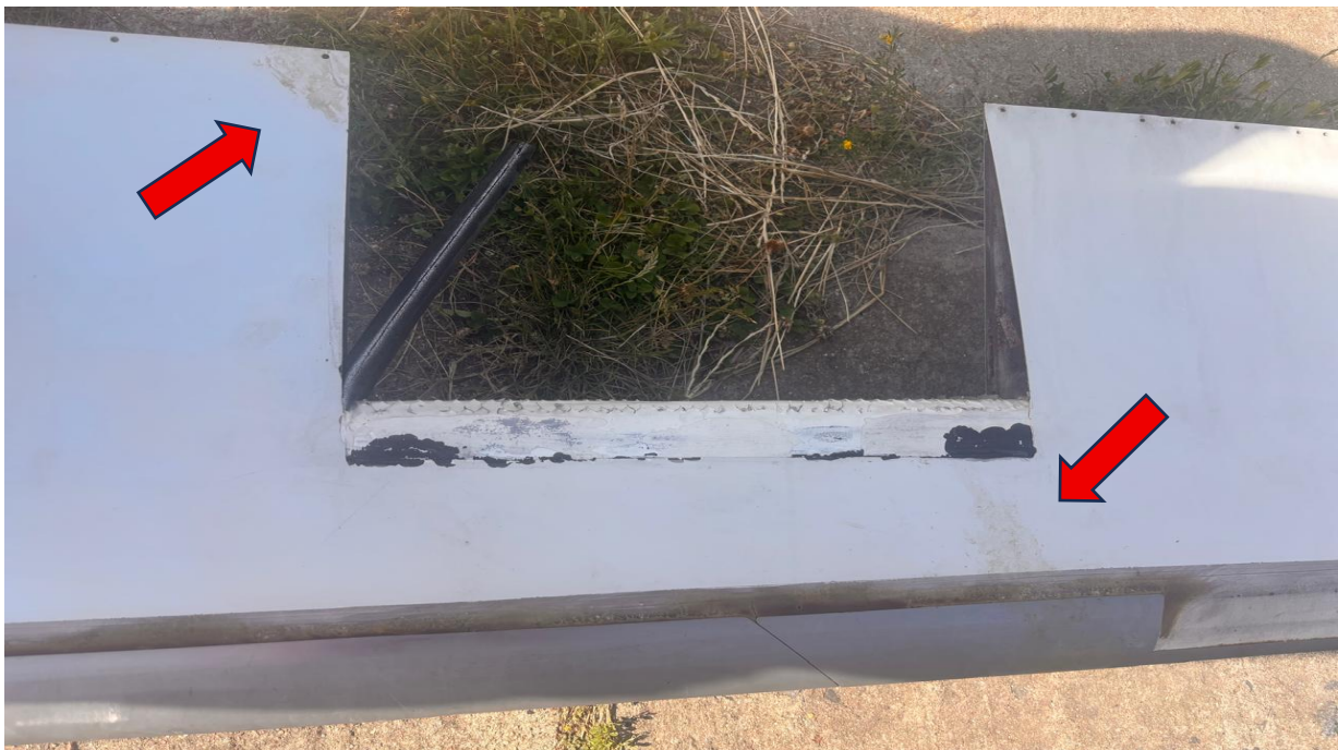
Пошкодження третьої лопаті нижнього несучого гвинта № 7407УГ. (Вид зверху)
