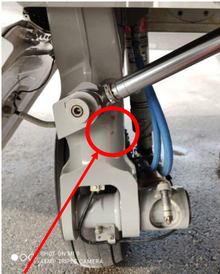
Рис. 2. Фото правої опори шасі із червоною відмітиною від підпружинених маркерів бічних вогнів ЗПС.
