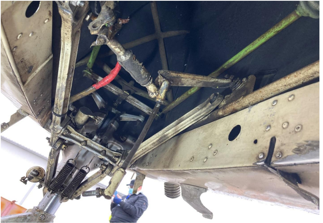
нижня обшивка обох закрилків в корневій частині протерта;
