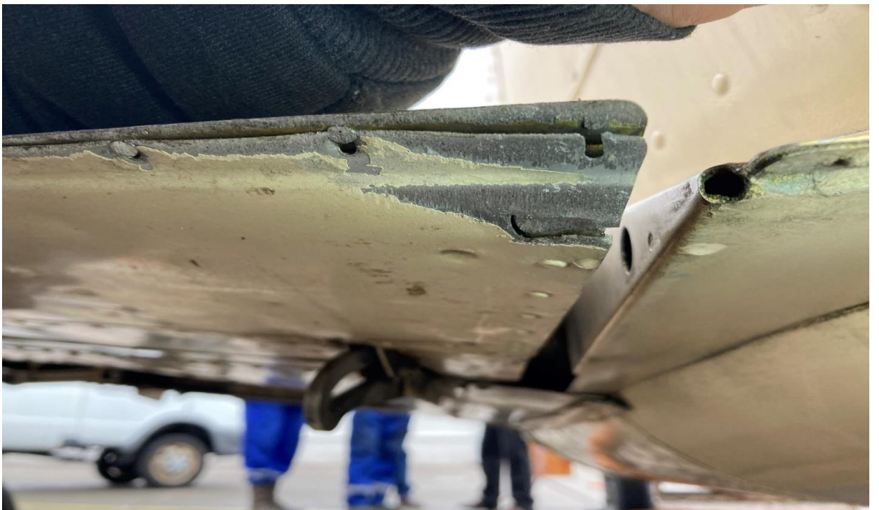
нижня обшивка обох закрилків в корневій частині протерта;
