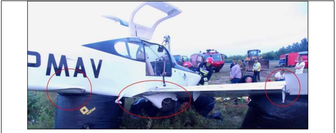
Рис. 5. Пошкоджений літак - вид з правого боку. Видима пошкоджена права основна опора шасі, праве крило, нижня частина фюзеляжу і зламаний елерон [джерело: РКБWL]
