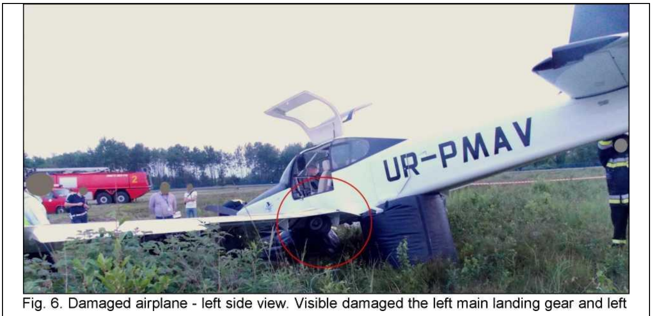
Рис. 6. Пошкоджений літак - вид с лівого боку. Видима пошкоджена ліва основна опора шасі і ліве крило [джерело: РКБWL]
