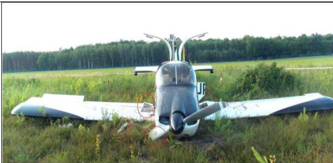
Рис. 4. Пошкоджений літак - вид спереду. Видимий пошкоджений повітряний гвинт, крила і відокремлена носова опора шасі [джерело: РКБWL]
