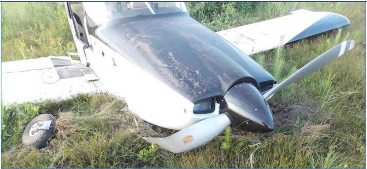
Рис. 10. Відокремлене носове колесо і зігнута лопать повітряного гвинта. [джерело: РКВЛ]
