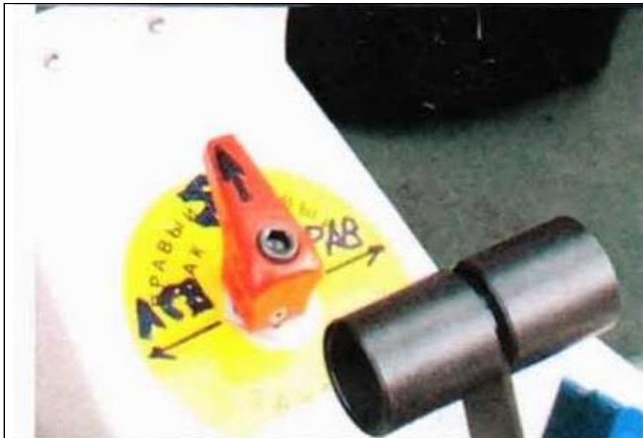
Рис. 13. Позиція установки паливорозподільного крана після аварії. Фотографія показує позиції установки клапана, що позначені фломастером на заводській наклейці та адаптовані до фактичних параметрів установки клапана на цьому літаку [джерело: РКВWL]
