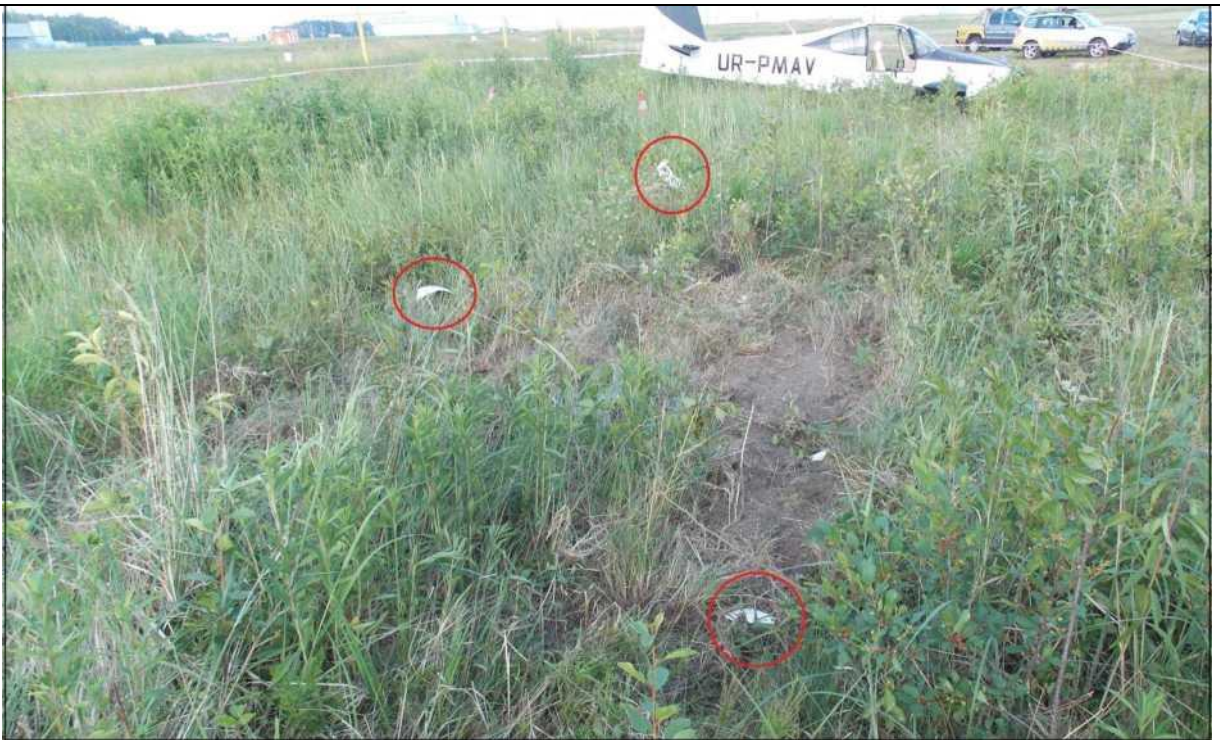
Рис. 11. Сліди торкання землі і фрагменти обтічників опори шасі [джерело: РКВЛ]
