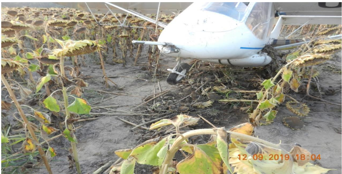
ФОТО 2 деформована передня стійка шасі;
