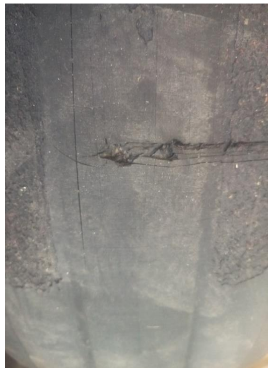
Фото 2. Стан шини № 3: знос, поперечні порізи, ревулканізація
