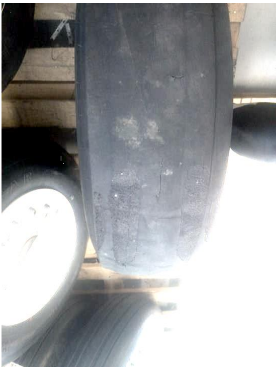
Фото 1. Стан шини № 4: знос, повздовжні порізи, ревулканізація
