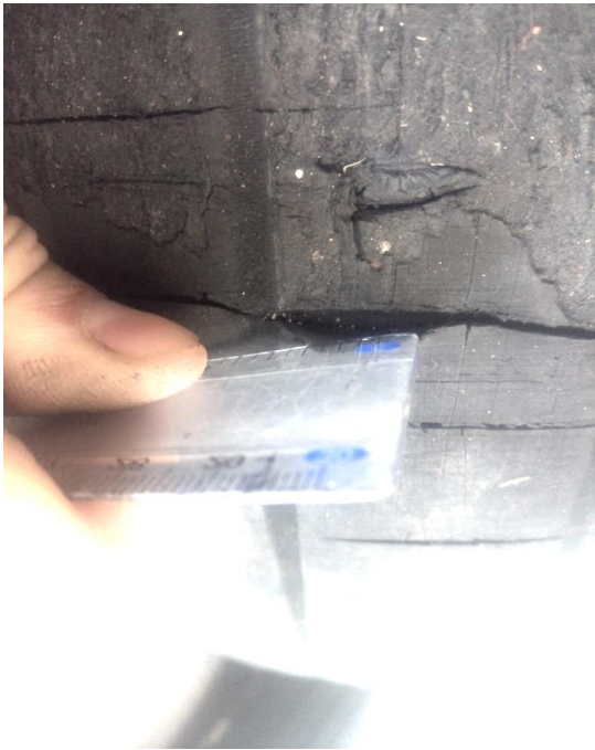
Фото 3. Шина №2: знос, порізи, вириви матеріалу, ревулканізація
