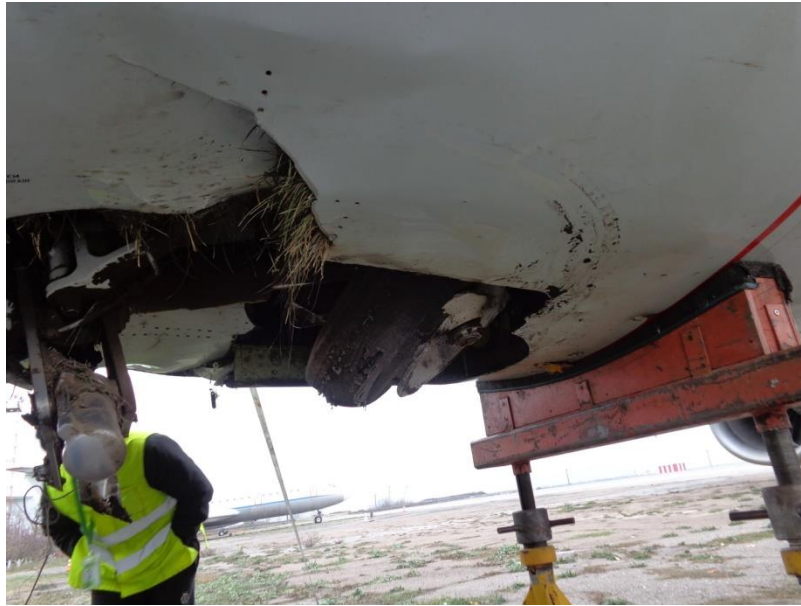
Фото 2. Руйнування нижньої обшивки фюзеляжу через складання ПОШ
