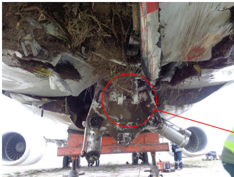
Фото 3. Вузол кріплення тяги прибирання-випуску ПОШ
