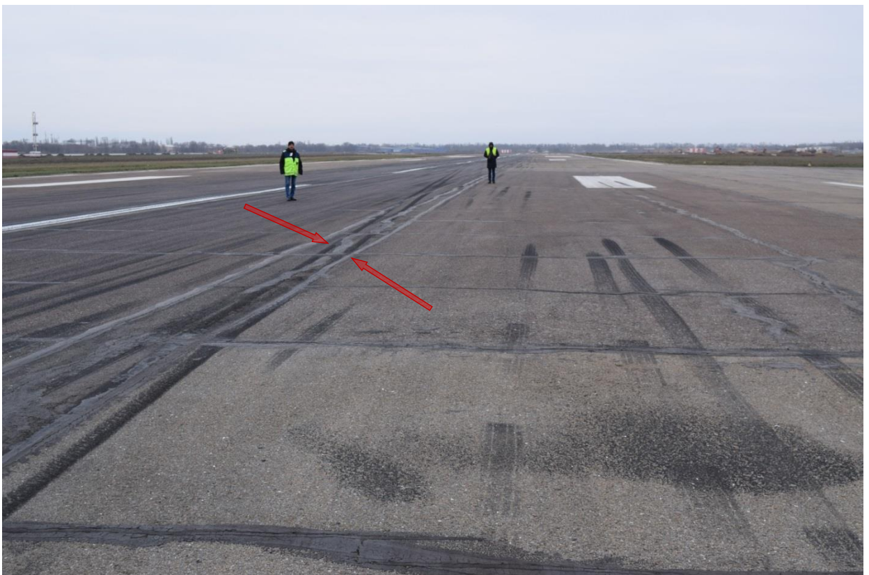
Фото 25. Подвійний слід від передньої опори шасі
