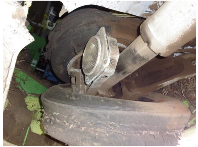
Фото 7. Руйнування пневматиків ПОШ
