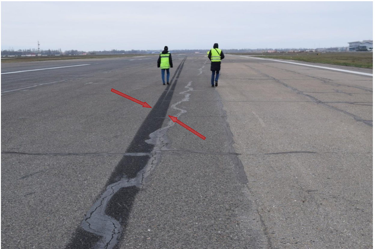
Фото 26. Початок суцільного сліду від пневматиків передньої опори шасі (початок руху літака юзом)
