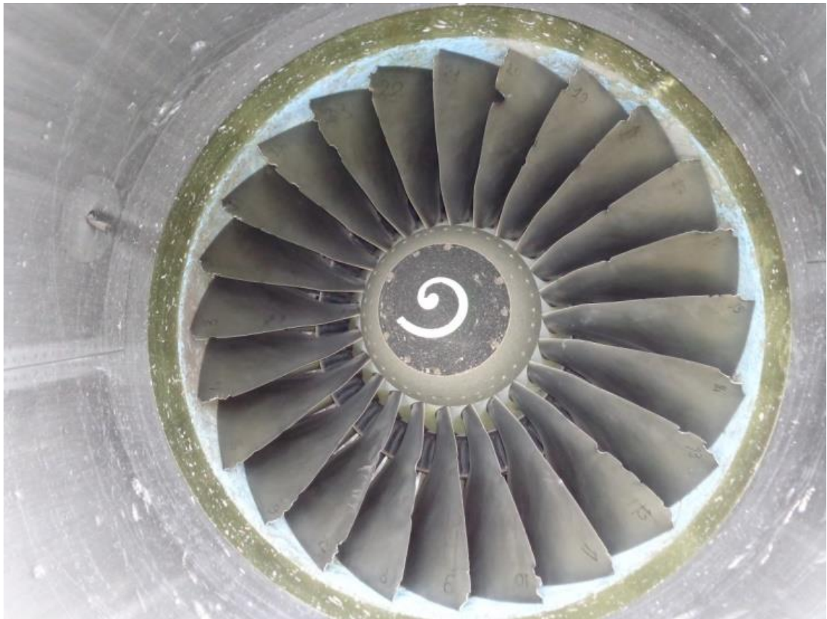
Фото 13. Пошкодження акустичної панелі та усіх лопаток двигуна №1
