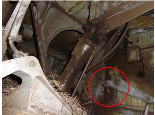
Фото 11. Вузол механізму прибирання-випуску лівої стулки ПОШ
