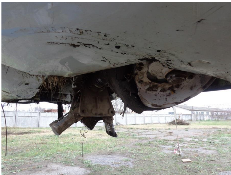
Фото 1. Положення ПОШ після події
