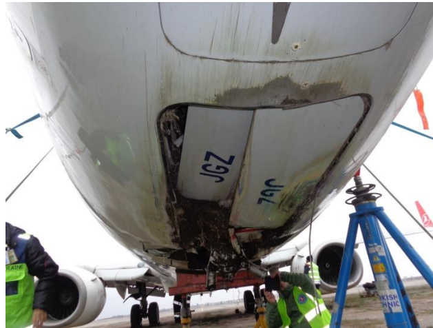
Фото 12. Пошкодження стулок ПОШ
