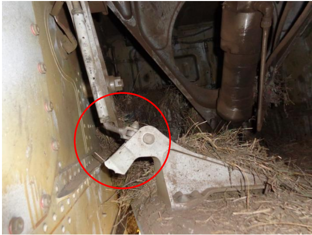
Фото 10. Вузол кріплення та прибирання-випуску правої стулки ПОШ
