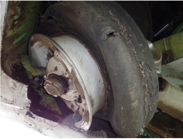
Фото 6. Руйнування лівого колеса ПОШ
