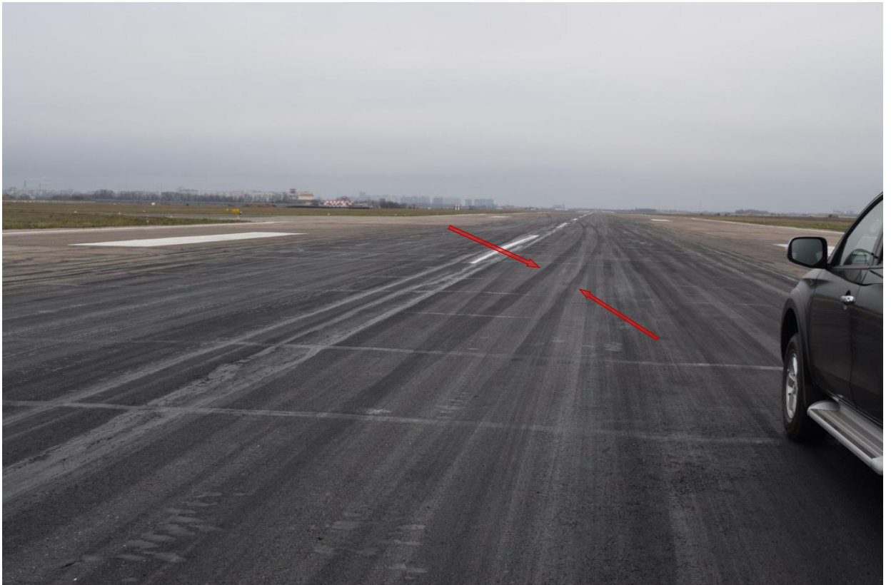
Фото 23. Початок сліду правої основної опори шасі після приземлення
