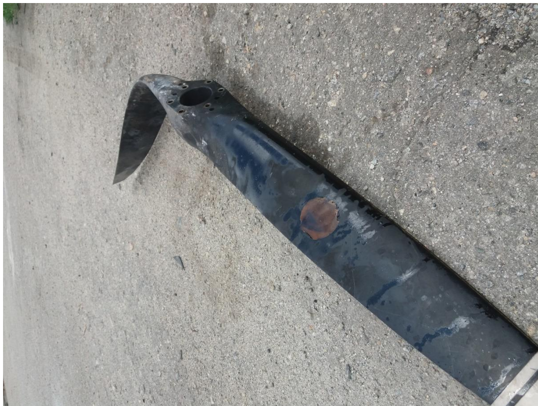
Фото 3 (руйнування повітряного гвинта)
