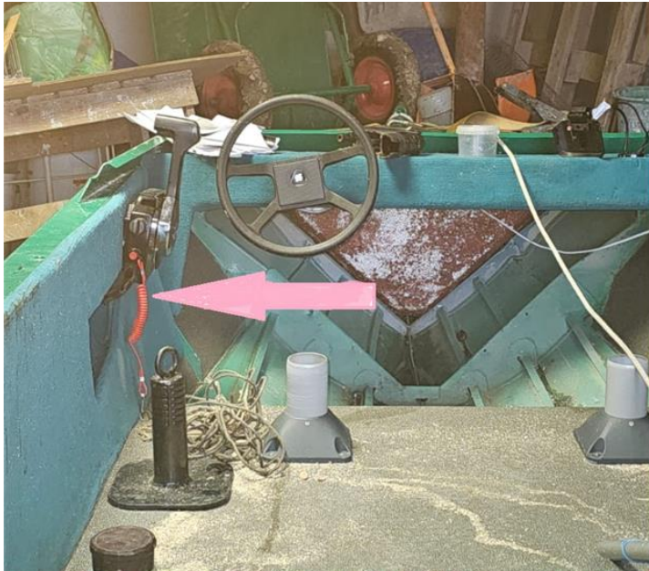
Мал. 11. Пристрій аварійної зупинки мотора показано стрілкою).
