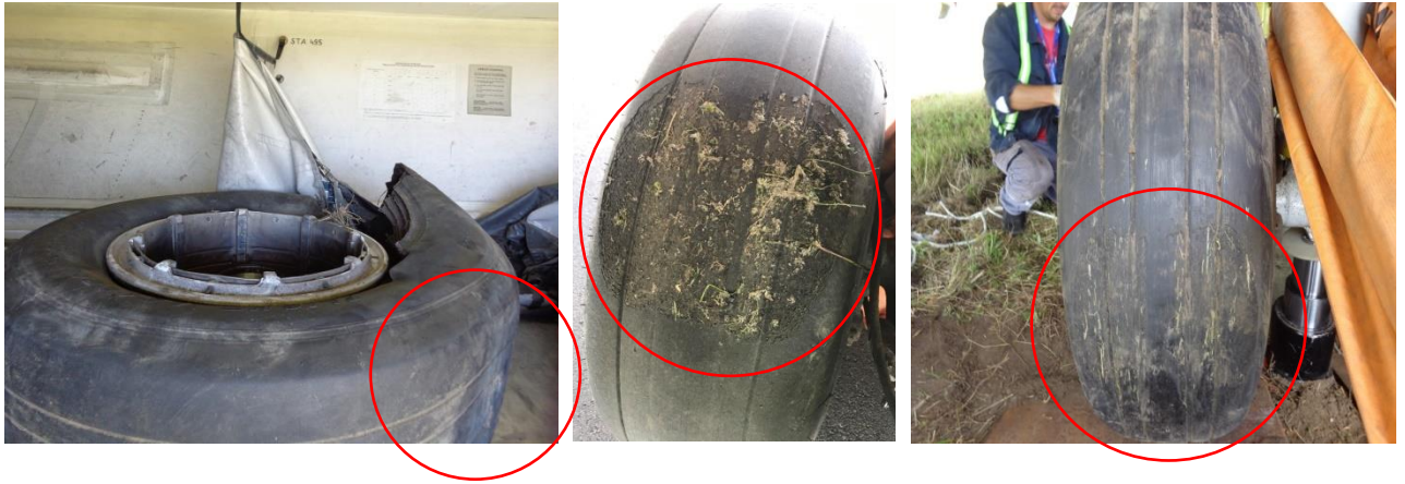
Фото 4. Сліди гальмування та глісирування на шинах коліс №1, №2 та №3 лівої та правої основних опор шасі
