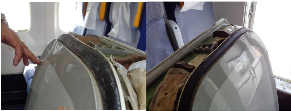
Старе ущільнення аварійного
