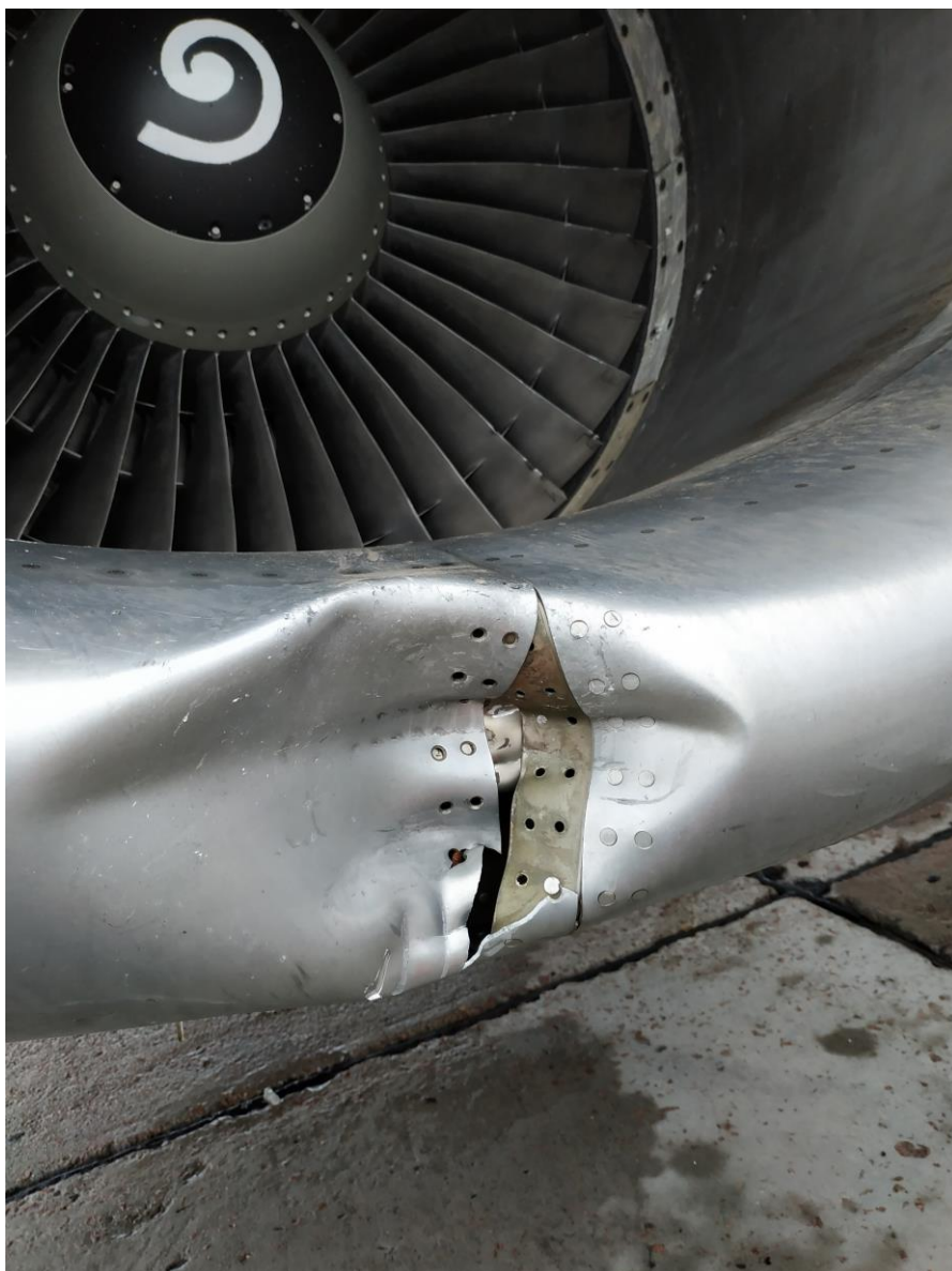
Фото 2. Повреждения ВНА СУ №2
