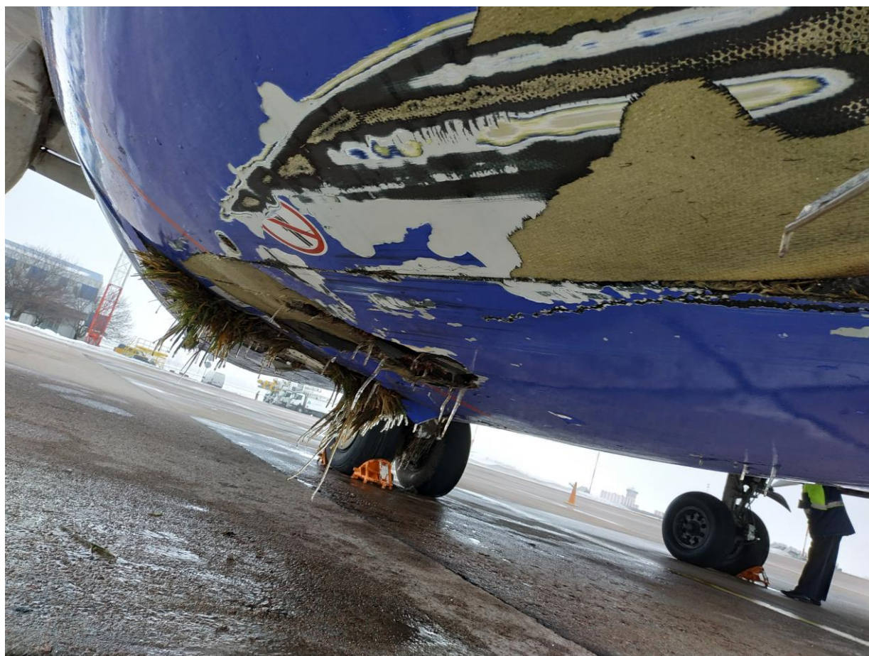
Фото 1. Разрывы композитной обшивки в нижней части правого капота вентилятора СУ №2
