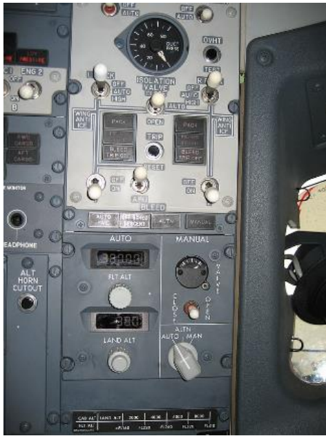
Мал.1 Панель керування системами кондиціонування та регулювання тиску
