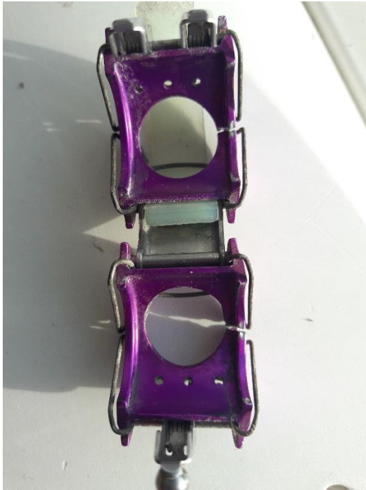
Мал.8. Муфта (Clamshell) деформація
